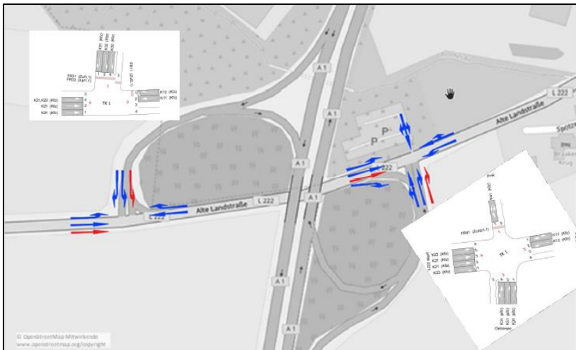
Abbildung 8: Struktur AS Stapelfeld mit Spurverdopplung aus Hamburg kommend, Quelle Verkehrskonzept: M+O Ingenieurgesellschaft für das Bauwesen mbH
